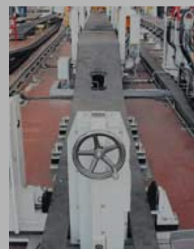
Diese Portalschweißanlage wird zum Unterpulverschweißen genutzt.
